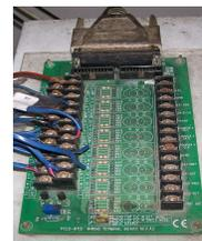
Gambar 4 Terminal REV.A2 untuk data akuisisi PCL-818HG
