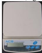
Gambar 7 Timbangan digital tipe Acis – 500
