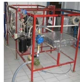
Gambar 3.1 Instalasi pengujian sistem water chiller
