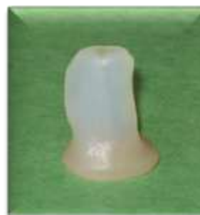
Gambar 14. Earmold yang terbuat dari vinyl, bagian tengahnya dilobangi dengan bor 14
