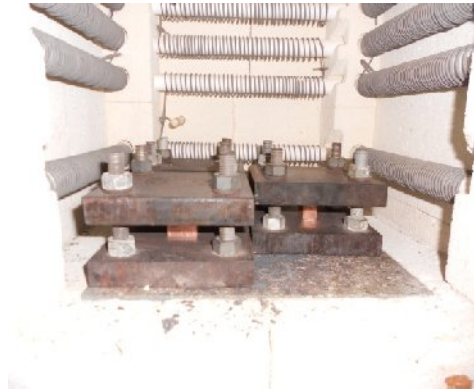
Gambar 3.5 Klem berisi material dimasukkan ke dalam tungku
