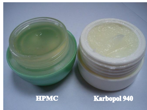
Gambar 6. Perbandingan Gel Minyak Atsiri Daun Jeruk Purut dengan Basis HPMC dan Karbopol 940
