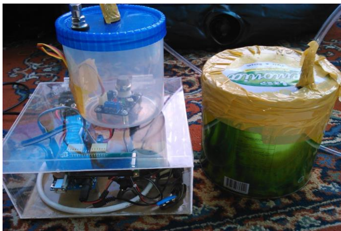
Gambar 3.4 Control Box yang Terhubung dengan Digester
