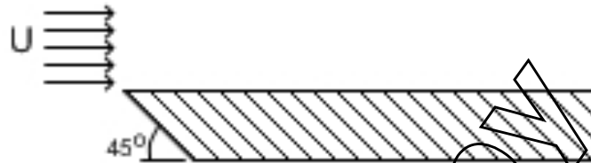
Gambar 5. Sisi ujung pelat dibuat tajam dengan kemiringan 45°
