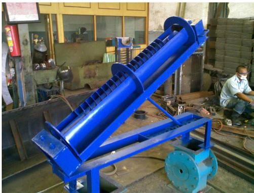
Gambar 4.2 Foto Turbin Screw yang Telah Dibuat Dilihat dari Samping
