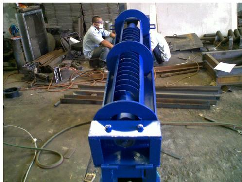
Gambar 4.3 Foto Turbin Screw yang Telah Dibuat Dilihat dari Depan
