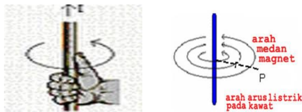
Gambar 1. Arah medan magnet disekitar penghantar arus
