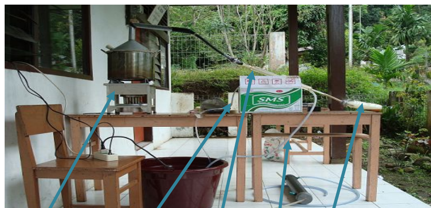
tungku pirolisis air keluar kondensor air masuk penampung asap cair
