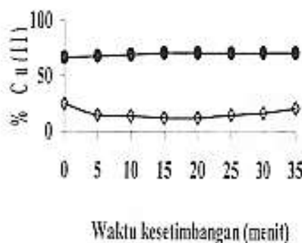
Gambar 7. Pengaruh lama pengadukan terhadap % transpor Cu(II) di fasa penerima (*) dan % Cu(II) sisa di fasa sumber
