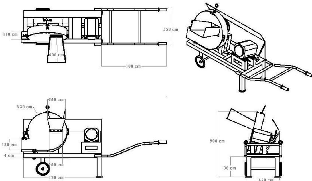
Gambar 1. Gambar Teknik mesin pencacah Rumput Gajah
