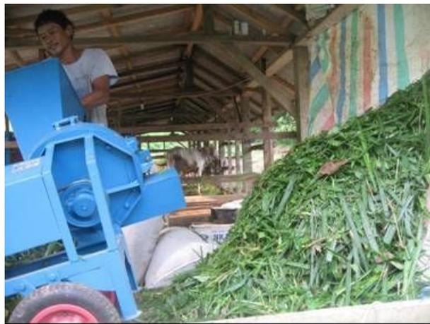
Gambar 3. Pengguna sedang mengoperasikan mesin pencacah
