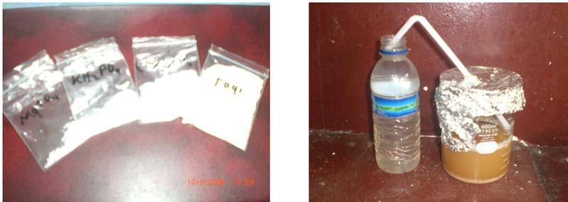
**Gambar 1. Proses pembuatan bioetanol skala laboratorium. (a) Kapang komersil dan zat yang diperlukan untuk nutrisi. (b) Proses fermentasi 250 mL ekstrak tebu.**
