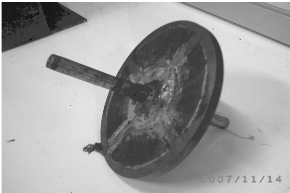
Gambar 4. Foto rotor khusus generator homopolar
