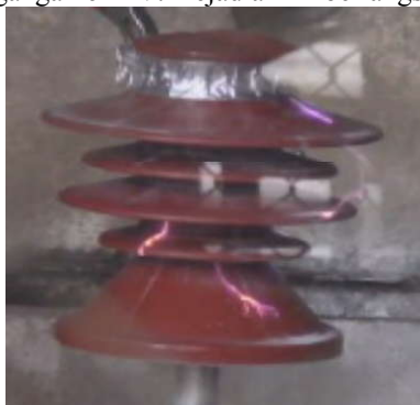
Gambar 4.4 Sparkover di permukaan isolator polutan 2600 \mu S/cm, Kelembaban Tinggi
