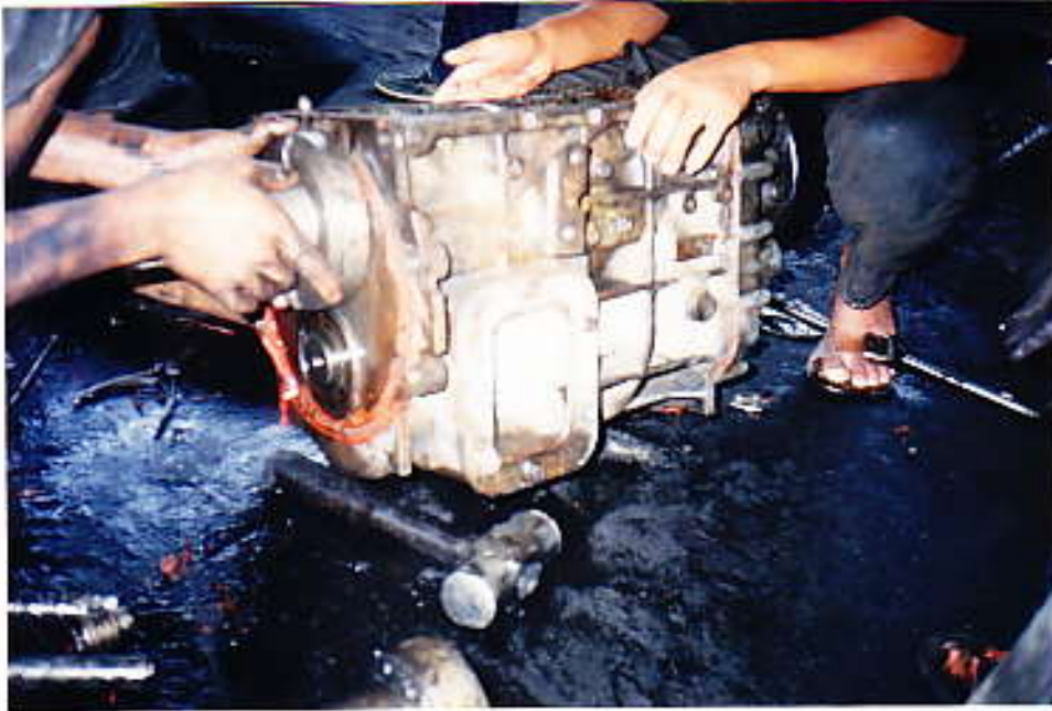
Pemasangan Trecker Pada Bearing Saat Uji Coba
