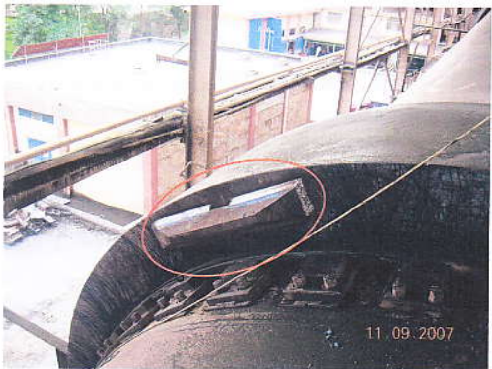
Gambar 2 Profil baja yang ditempel pada live ring
